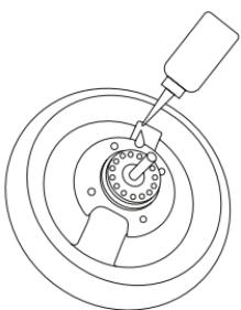
Bunun yanı sıra bebek arabasında, düzenli olarak yağlanıp kir ve sıvılar- dan korunması gereken sekiz adet rulman (her bir tekerde 2) vardır. Bu tür maddelerin içeri girmesi durumunda, rulmanlar temizlenmeli, kuru- tulmalıdır ve birkaç yağ daması ile yağlanmalıdır. Yağ dökülürse kuru bir bezle silinmelidir.
