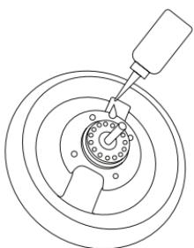
Okrem toho je v kočíku osem guľôčkových ložísk (2 v každom kole), ktoré by mali byť namazané pravidelne a chránené proti nečistotám a kvapalinám. V prípade, že sa takéto látky dostanú dovnútra, guľôčkové ložiská by mala byť vyčistená, vysušená a namazané niekoľkými kvapkami oleja. Akékoľvek rozliatiu oleja by malo byť utretie suchou látkou.
