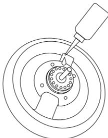
Außerdem befinden sich acht Kugellager im Kinderwagen (2 pro Rad), die regelmäßig geschmiert und vor Schmutz und Flüssigkeiten geschützt werden sollten. Falls solche Stoffe eindringen, sollten die Kugellager gereinigt, getrocknet und mit mehreren Öltropfen gefettet werden. Das ausgelaufene Öl sollte mit einem trockenen Tuch abgewischt werden.
