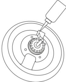
En plus de cela, il y a huit roulements à billes dans la poussette (2 dans chaque roue), qui doivent être graissés régulièrement et protégés de la saleté et des liquides. Au cas où de telles substances pénétreraient les roulements à billes, ils doivent être nettoyés, séchés et graissés avec plusieurs gouttes d'huile. Tout déversement d'huile doit être essuyé avec un linge sec.
