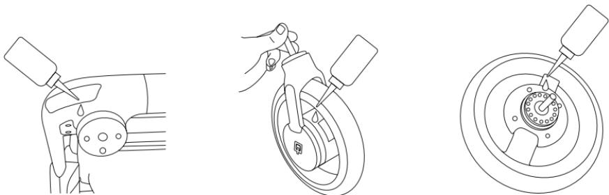
Poza tym w wózku znajduje się osiem łożysk kulkowych (2 w każdym kole), które należy smarować regularnie i chronić przed brudem i płynami. W przypadku dostania się takich substancji, łożyska kulkowe należy oczyścić, osuszyć i nasmarować kilkoma kroplami oleju. Wszelkie wycieki oleju należy przetrzeć za pomocą suchej szmatki.
