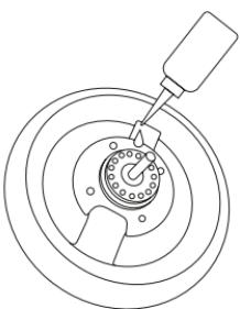
Utöver det finns åtta kullager i barnvagnens hjul (två i varje hjul) som behöver smörjas upp regelbundet och skyddad från smuts och fukt. Vid en händelse av att sådana substansertränger in, behövs hjulens kullager städas, torkas och smörjas med flera droppar olja. All olja som spills bör torkas upp med en torr trasa.
