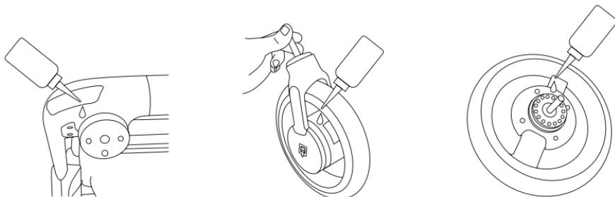
Adicionalmente, el coche de paseo tiene 8 rodamientos (2 en cada rueda) los cuales deben engrasarse regularmente y protegerse de la suciedad y de los líquidos. En el caso de que este tipo de sustancias penetren en los rodamientos, éstos deben limpiarse, secarse y engrasarse con varias gotas de aceite. Cualquier derrame de aceite que pueda ocurrir debe limpiarse con un paño seco.
