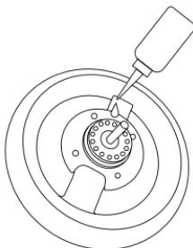
În plus, în cărucior există opt rulmenți cu bile (2 pe fiecare roată), care trebuie unși în mod regulat și protejați de murdărie și lichide. În cazul în care se depun astfel de substanțe, rulmenții trebuie să fie curătați, uscați și unși cu câteva picături de ulei. Orice scurgere de ulei se va șterge cu un material uscat.
