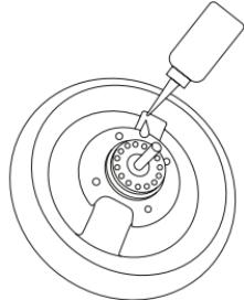
Kromě toho je v kočárku osm kuličkových ložisek (2 v každém kole), které by měly být namazány pravidelně a chráněny proti nečistotám a kapalinám. V případě, že se takové látky dostanou dovnitř, kuličková ložiska by měla být vyčištěna, vysušena a namazána několika kapkami oleje. Jakékoli rozlití oleje by mělo být otřeno suchou látkou.
